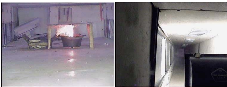
深埋地铁车站火灾模型实验
