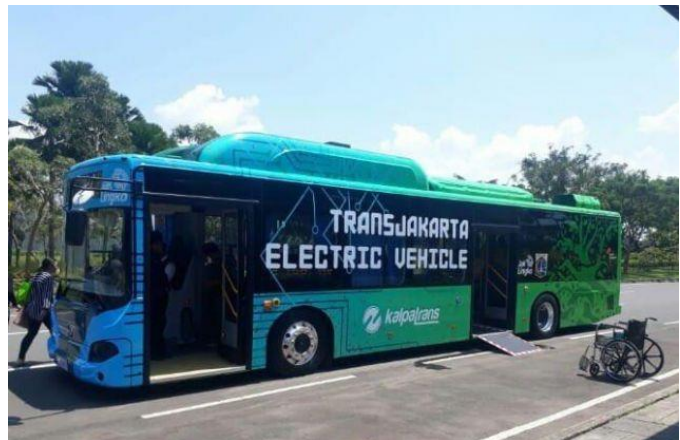
-Single Bus 12 meter -Brand : BYD Type K9 -Dimension : (12 x 2,5 x 3,4) m
