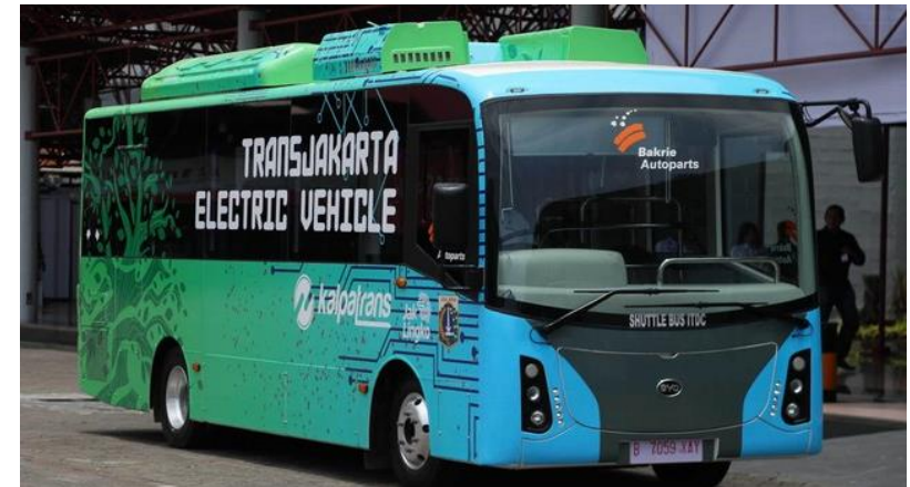
-Medium Bus 7 meter -Brand : BYD Type C6 -Dimension : (7 x 2,1 x 3) m
